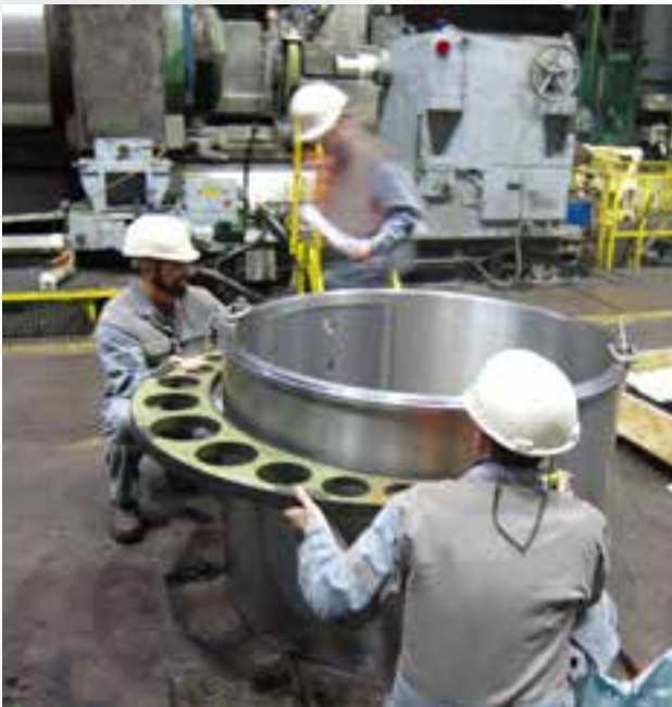
Medición de un casquillo de cojinete
